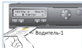
Устанавливаем карту водителя в левый слот тахографа вверх чипом и от себя до характерного щелчка.
