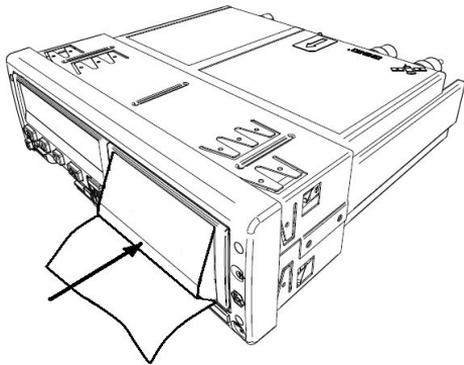
4. Поместите лоток с установленным рулоном в тахограф. Для установки крышки в исходное положение, нажмите на нижнюю часть крышки лотка для бумаги. Принтер готов к работе.
