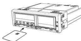
2 Устанавливаем карту водителя в левый слот тахографа вверх чипом и от себя до характерного щелчка.
