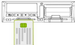
Устанавливаем карту водителя в левый слот тахографа вверх чипом и от себя до характерного щелчка.
