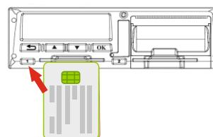
По завершении смены вынимаем карту длительным нажатием на кнопку того слота, в котором она установлена. В большинстве случаев — необходимо нажать и держать кнопку «1».
