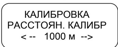
Измеряемое расстояние для автоматической калибровки (режим автоматического подсчета импульсов и расчета коэффициента ТС) задается в диапазоне от 20 до 1000 м.
