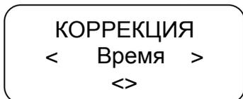
Для проведения коррекции времени нажать кнопку «←». При помощи кнопок «<1», «2>» откорректировать значение времени. На индикаторе мигает значение минут, т.к. возможна коррекция в пределах 1 мин с интервалом не менее семи дней.
