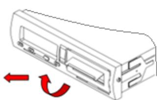
Поднять крышку ТПУ вверх и выдвинуть механизм ТПУ, потянув за крышку на себя.
