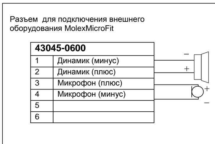
Примечание – для обеспечения голосовой связи могут быть использованы: микрофон электретный НМО0603А, 3 В, 6 мм и динамик QP2840CP08-18-R (8 Ом 2 Вт) или аналогичные по характеристикам.
