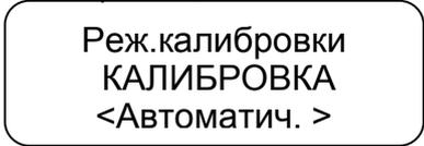
При помощи кнопок «<1», «2» выбрать тип калибровки: автоматическая или ручная. Нажать кнопку «↵»:
